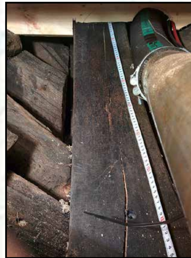
Bjørnen som holder sammen på agterskibet. Revnerne, som opstod under Fyn Rundt, ses tydeligt nederst i billedet.
