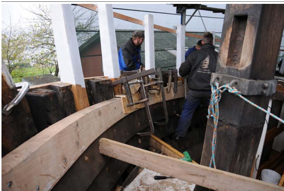
Egersund: Efter isætning af nye lønningsstøtter og del af dårlig bjælkevæger (Øverste billede), blev dårlige dæksbjælker udskiftet i forskibet (nederste billede) Foto: Jens C. øverste billede og Christian Mikkelsen nederste billede.
