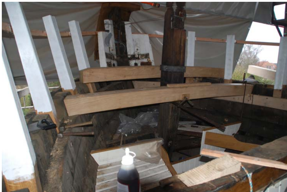
Egersund: Efter isætning af nye lønningsstøtter og del af dårlig bjælkevæger (Øverste billede), blev dårlige dæksbjælker udskiftet i forskibet (nederste billede) Foto: Jens C. øverste billede og Christian Mikkelsen nederste billede.
