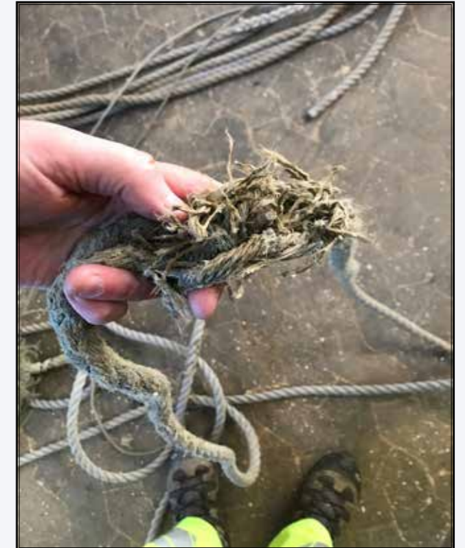
Ved gennemgang af tovværket findes et tov med en skade, der gør at det skal udskiftes.
